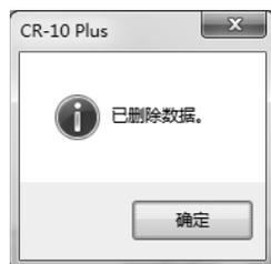
**注释** 操作“删除仪器中数据”后，通过“读取”读取到 PC 应用程序中显示的数据也会同时被删除。
