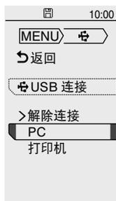
**备注** 屏幕显示“正在连接 PC”时，按下 MENU/OK 键，将断开与 PC 的连接。
